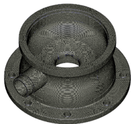
图4 离心泵泵头的网格分布
